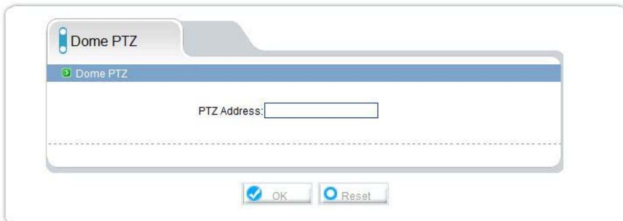
Le telecamere motorizzate speed dome serie RH sono munite di una porta RS485 che permette di controllarle i movimenti con una tastiera per speed dome con protocollo Pelco P/D. In questa finestra è possibile inserire l'indirizzo RS485 della telecamera da digitare sulla tastiera per poterla comandare. I dati di comunicazione si impostano successivamente nella sezione EXTERNAL DEVICE.
