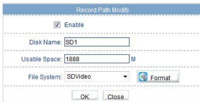
Cliccare FORMAT ed attendere il completamento della formattazione. Sono disponibili 2 modalità di file system per la formattazione: SD Video e EXT3. Ai fini pratici i due file system sono equivalenti: SD Video è un file system proprietario mentre EXT3 è il file system utilizzato da sistemi GNU/LINUX.
