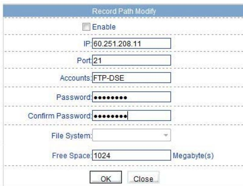
Nella finestra si possono inserire tutti i parametri di accesso del server FTP: indirizzo, porta, e dati di accesso. Nella casella FREE SPACE è possibile inserire uno spazio di memoria da lasciare libero per evitare di occupare tutto l'hard disk del server e metter in difficoltà il sistema operativo.
